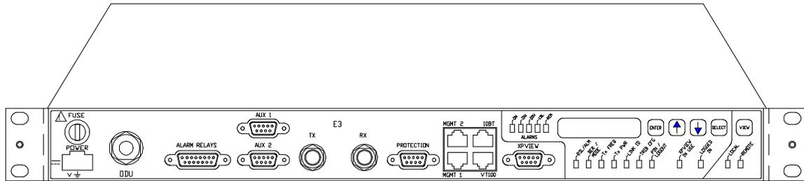
Figure 1-3. Unbalanced E3 or DS3 IDU
