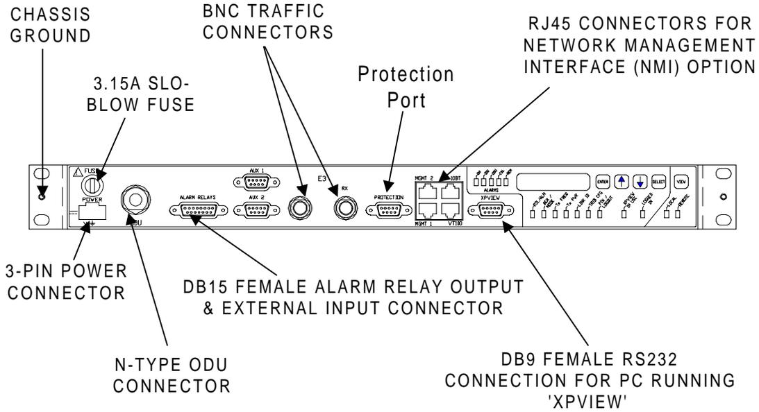
Figure 3-5b. XP4 E3 and DS3 IDU Connectors
