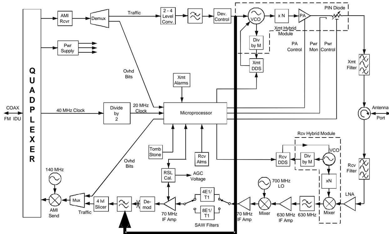
Figure 6-4. ODU Analog Loopback
