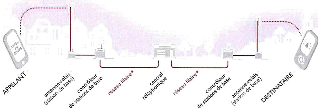
Le téléphone mobile communique par ondes radio avec l'antenne-relais du réseau de votre opérateur la plus proche. Le signal reçu est ensuite véhiculé via le réseau téléphonique filaire jusqu'au destinataire de l'appel.
