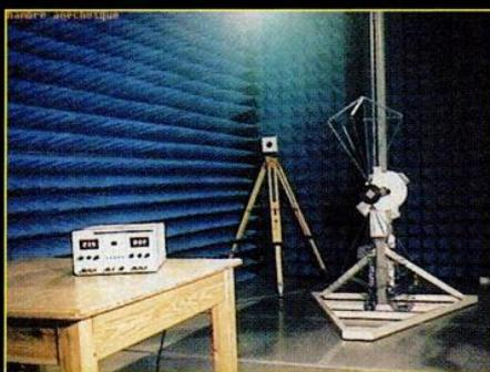
Les tests de sensibilité de *Mobiles magazine* sont réalisés par GEB (Général électronique de Brive), en chambre anéchoïque radio.
