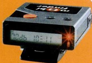
Encourager le savoir-vivre sans rentrer dans l'illégalité : c'est ce que permettent les détecteurs de mobiles, comme celui-ci. L'écran indique la puissance du signal radio et permet de localiser dans une salle le porteur d'un téléphone allumé.
