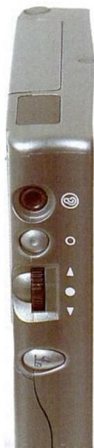
◀ Sur le côté gauche en haut de l'appareil, le port infrarouge. Le déplacement dans les menus est assuré par la molette de navigation.
