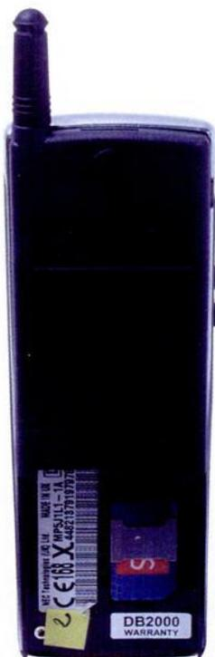
La batterie lithium ne pèse que 44 grammes et préserve le profil rectiligne du dos du DB2000.
