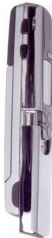
▲ **Sur le côté gauche de l'appareil, les deux touches de réglage du volume, en haut, et le port infrarouge, en bas**
