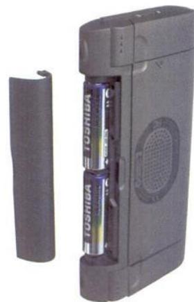
L'alimentation du Psion Series 3mx est assurée par deux simples piles au format LR6
