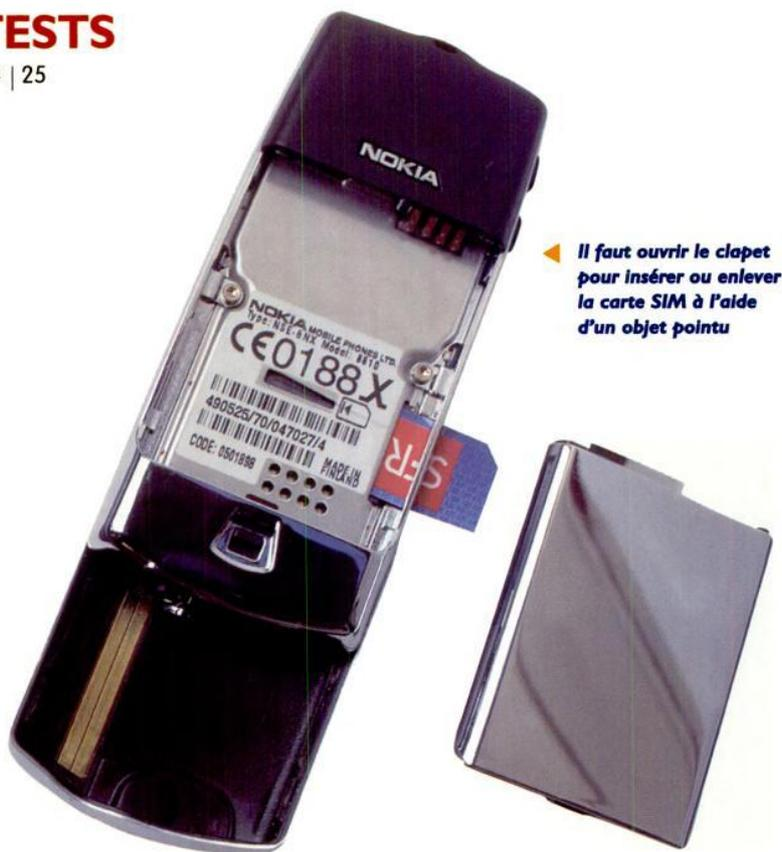
▲ **Il faut ouvrir le clapet pour insérer ou enlever la carte SIM à l'aide d'un objet pointu**
